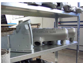
Perfektion in Grau: Sandguss-Teil nach Fertigstellung
