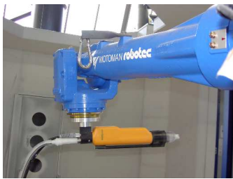
Der zur Pulvermaschine umgebaute UP50N der Fa. MOTOMAN robotec
